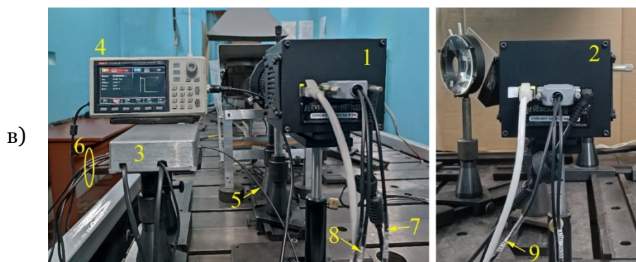
Рис. 4. Схема синхронизации на основе платы микроконтроллера STM32F103C8T6. а – последовательная синхронизация; б – параллельная синхронизация; в – фотография блока синхронизации и подключения скоростных камер. 1 – ведомая камера 1 (в составе лазерного монитора); 2 – ведомая камера 2 (боковая камера); 3 – блок синхронизации; 4 – внешний генератор; 5 – оптический канал “OPT IN”; 6 – выходы и входы блока синхронизации; 7 – вход “EXT SYNC IN” ведомой камеры 1; 8 – выход “EXT SYNC OUT” ведомой камеры 1; 9 – вход “EXT SYNC IN” ведомой камеры 2.
